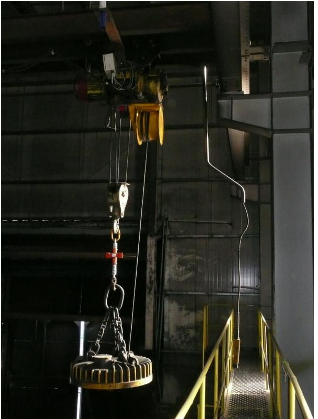
Фото 3. Работа весов с магнитной шайбой.
