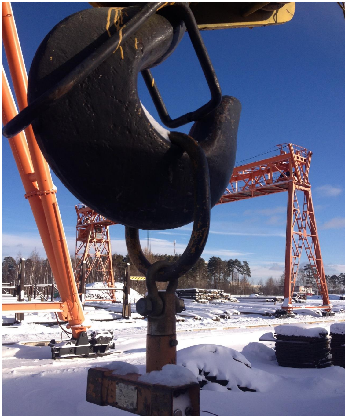
Фото 5. Пятитонные весы МК-5000Д подвешены на крюк крана (предположительно 30 тонн) с помощью кольца большего калибра.
