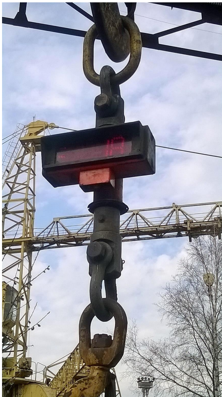
Фото 4. На весы МК-10000С установлен крюк с вертлюгом.
